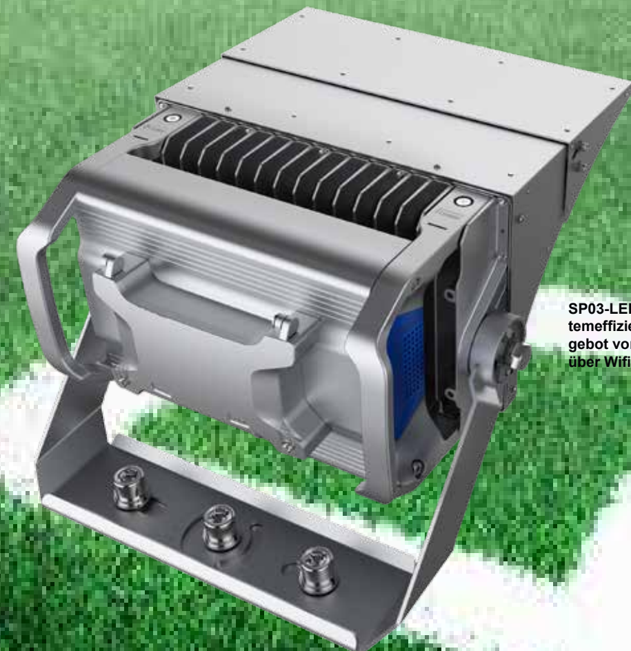
SP03-LED-Matrixscheinwerfer mit 2000W Systemleistung, 2-fach kippbaren Blendensystem, Gesamtlichtstrom 300.000 lm und separater Platzierung der EVG-Box am Tragwerk
