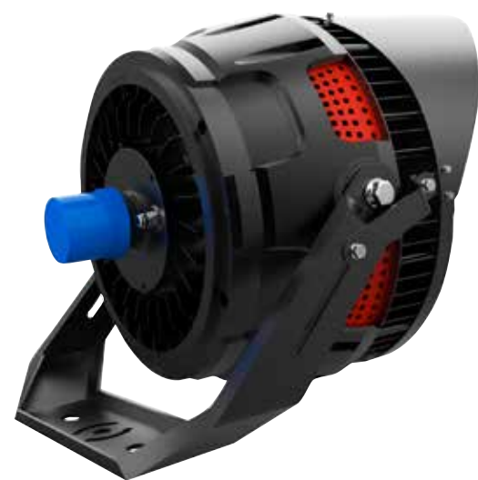
SP06-Flutlichtmodul mit Rotixentlüftung zur optimalen Wärmeabführung und integrierter Wifi-Antenne, LED-Matrixplatten und Linsensätze austauschbar
